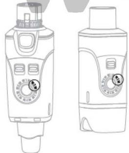
3. Zapněte přijímač a vysílač. Zkontrolujte, zda máte shodně nastaven kanál.
