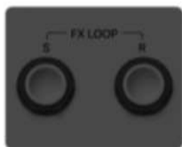
(Jednoportowy stereo FX LOOP) (prześciółka TRS do podwójnego TS, kabel Y)
