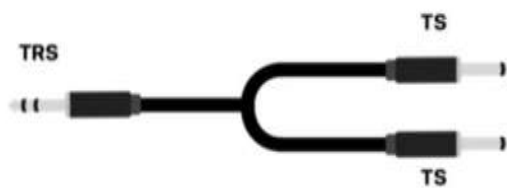
(Jednoportowy stereo FX LOOP) (prześciółka TRS do podwójnego TS, kabel Y)
