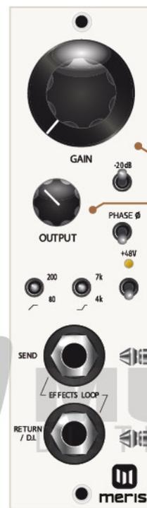
**7** Stellen Sie den 440 auf Unity-Gain ein, und verwenden Sie den Effekteinschleifweg, um Pedals in den Mix einzufügen.
