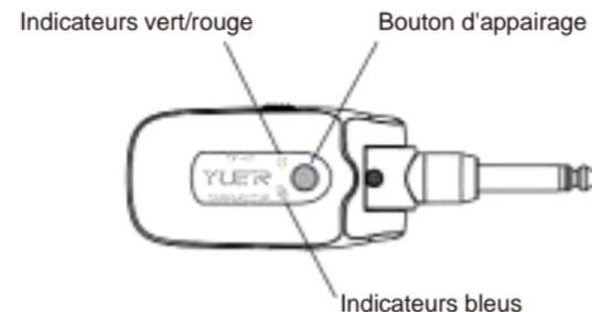
Allumez l'émetteur et le récepteur, appuyez sur le bouton d'appairage du récepteur jusqu'à ce que l'indicateur bleu clignote rapidement. Appuyez ensuite sur le bouton d'appairage de l'émetteur pendant plus de 2 secondes. Lorsqu'ils sont jumelés avec succès, les indicateurs bleus sur l'émetteur et le récepteur sont allumés.
