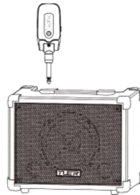
Allumez le récepteur, si son voyant bleu est allumé, cela indique que le récepteur et l'émetteur sont appairés. Si l'indicateur bleu clignote, cela indique qu'ils ne sont pas appairés. Cela peut être dû à une forte interférence de signal, à une distance de transmission excessive ou un dysfonctionnement de l'émetteur.
