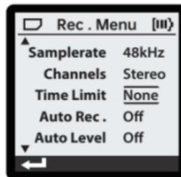
Drücken Sie zur Navigation durch diese Menüs PLUS oder MINUS, um die Auswahl nach oben bzw. unten zu bewegen. Der ausgewählte Eintrag wird mit einem schwarzen Rand darüber und darunter gekennzeichnet. Wenn ein Eintrag ausgewählt ist, können Sie über PLAY oder VOR damit interagieren. Wenn der Eintrag ein Untermenü hat, öffnet sich dadurch das entsprechende Untermenü. Wenn der Eintrag ein Parameter ist, führt diese Auswahl zum Parameterwert, der über PLUS / MINUS eingestellt werden kann.
