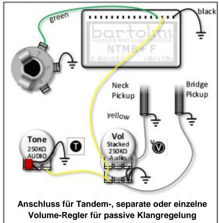
⚡ Masse (Ground) – Verbindung über vorinstallierten blanken Draht. Stellen Sie eine Verbindung zur Abschirmung im E-Fach her (sofern vorhanden).
