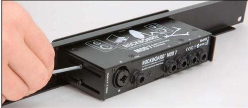
Placez votre **RockBoard®** MOD dans l'emplacement dédié au montage et utilisez le tournevis TX10 pour serrer les vis M3 x 4 mm à travers le support de montage dans les filetages situés sur les deux côtés de votre MOD pour le verrouiller en position.
