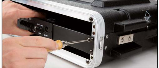
Placez le **RockBoard®** 19" Rack Panel dans votre rack 19", puis montez le panneau avec un tournevis cruciforme et les vis des rack incluses.
