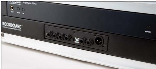
La plaque amovible à l'avant du **RockBoard®** MOD est plus haute que l'U standard, elle peut ainsi chevaucher vos appareils au format rack au-dessus ou en-dessous de votre **RockBoard®** 19" Rack Panel. Si cela pose problème, vous pouvez ôter la plaque avant de votre MOD en retirant les vis à l'aide d'un tournevis cruciforme PH2. Les écrous de montage des prises jack n'ont pas besoin d'être retirés.
