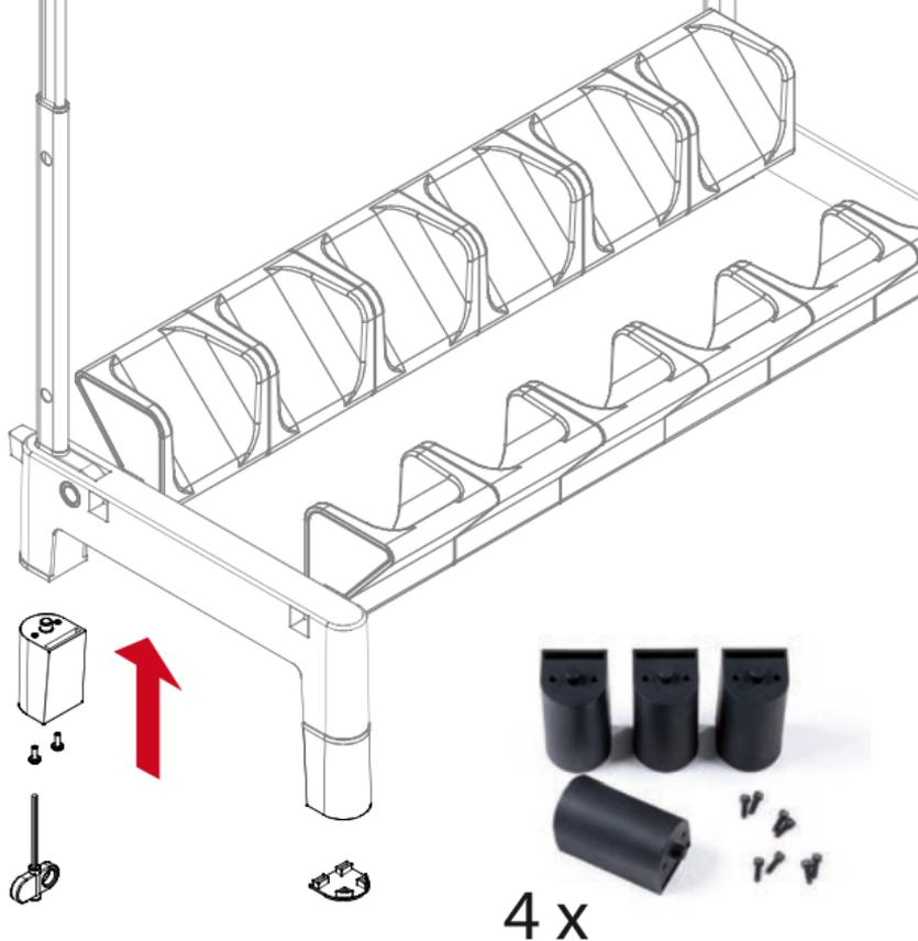
Standfußhöhung, z. B. für extrem lange V-Style Gitarren
