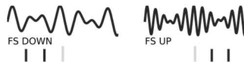
Beginnen Sie mit der in der Abbildung dargestellten Ring-Mod Einstellung. Mit dem RING MOD / FREQ SHIFT Regler werden die Pegel des oberen und unteren Seitenbandes eingestellt, um zwischen Frequenzverschiebung und Ringmodulation zu mischen.
