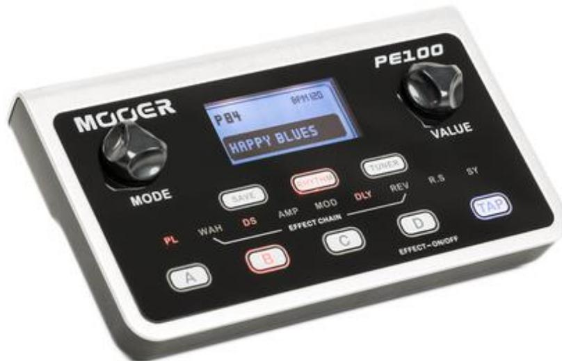
*Das Moer PE100 ist eine portable Multieffekt-Lösung, mit Gitarreneffekte, Amp-Modellen und einer Drumcomputer/Metronom-Funktion.*
