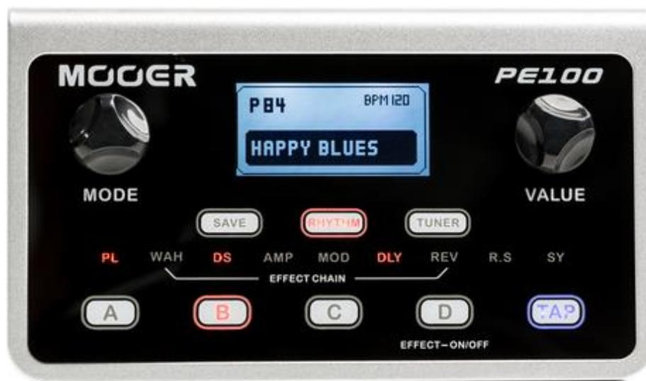
*Sämtliche Bedienelemente sind auf der Oberseite des PE100 angebracht.*
