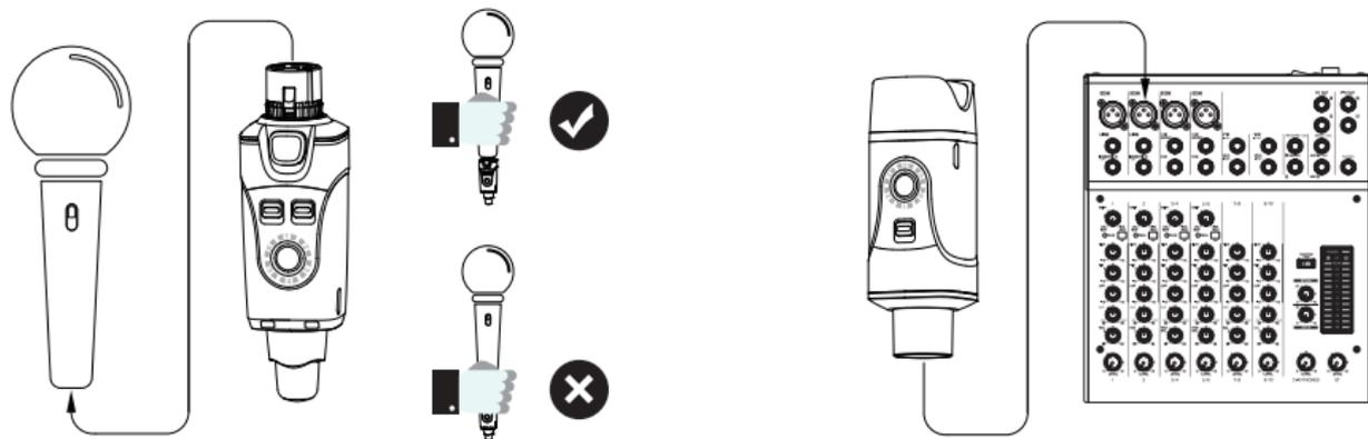
1. Stecken Sie den Sender (Transmitter) an die XLR Buchse an Ihrem dynamischen Mikrofon oder batteriebetriebenen Kondensatormikrofon an.
