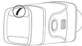
4. Nach erfolgreichem Verbindungsaufbau leuchtet die LED am U3 Empfänger durchgängig.
