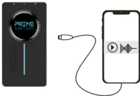
Für die Verbindung mit einem mobilen Gerät ist möglicherweise ein OTG-Kabel / Adapter (USB-C auf USB-A-Buchse) erforderlich (separat zu erwerben). Sie können das mitgelieferte USB-C-auf-USB-A-Kabel für den Anschluss an einen Computer verwenden.
