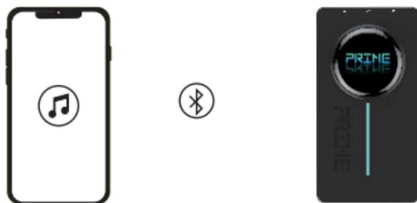
**Kopplung:** Öffnen Sie das Bluetooth-Menü Ihres Mobilgeräts, suchen Sie nach einem neuen Gerät, wählen Sie „Prime Audio“ aus und bestätigen Sie den Verbindungsaufbau.
