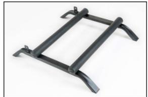
2. Nehmen Sie die **Steher (3)** und schrauben Sie diese an die angewinkelten Klappenösen an den **FüÙen (2)**. Verwenden Sie eine **kurze Sockelschraube (D)**, eine **Unterlegscheibe (E)** und eine **Hutmutter (H)** um die **Steher (3)** an den **FüÙen (2)** zu fixieren. Benutzen Sie den **Schraubenschlüssel (A)** und den **Sechskantschlüssel (B)**, um die Muttern festzuziehen.
