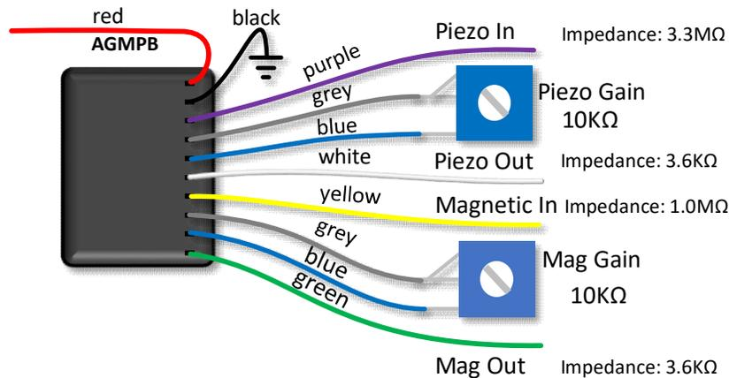
Das folgende Schema zeigt den Anschluss eines AGMPB und des 25KMN Blend-Potentiometers, um ein Piezo-Signal und ein magnetisches Signal in einen gemeinsamen Ausgang für die Verbindung zu einem EQ-Vorverstärker, einer aktiven Lautstärkeregelung oder direkt zur Ausgangsbuchse zu mischen.
