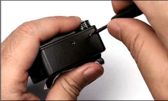
Damit ist der Akkuwechsel am U4 Empfänger abgeschlossen. Bitte schließen Sie das U4 an ein geeignetes Ladegerät an und laden Sie den neuen Akku vollständig auf.
