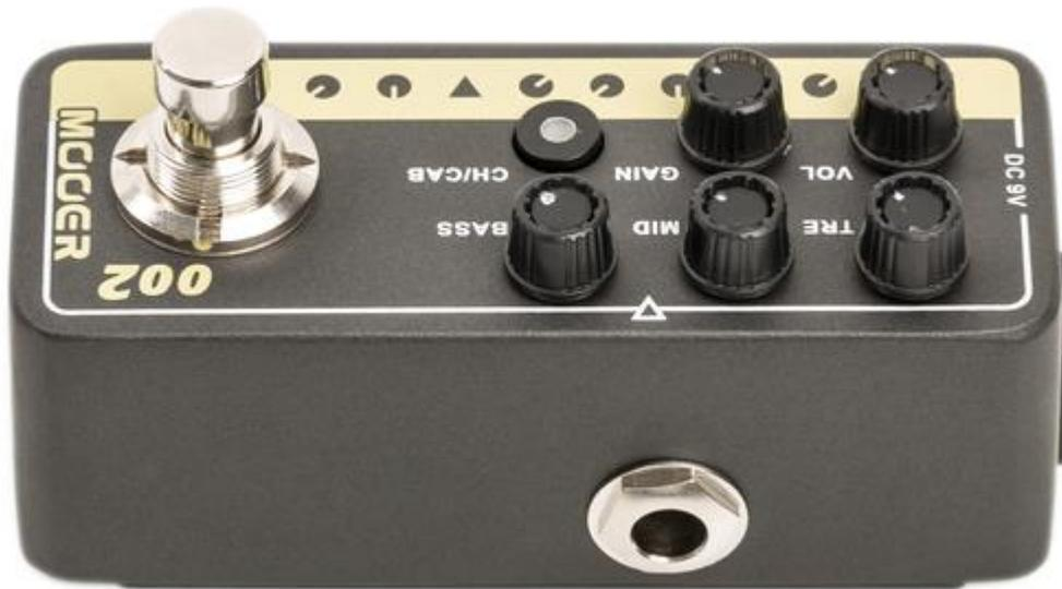
*Die Ein- und Ausgänge sind auf den Gehäuseseiten montiert...*
