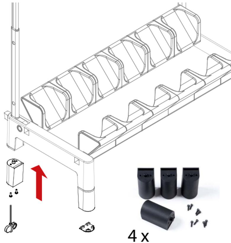
Standfußerhöhung, z. B. für extrem lange V-Style Gitarren
