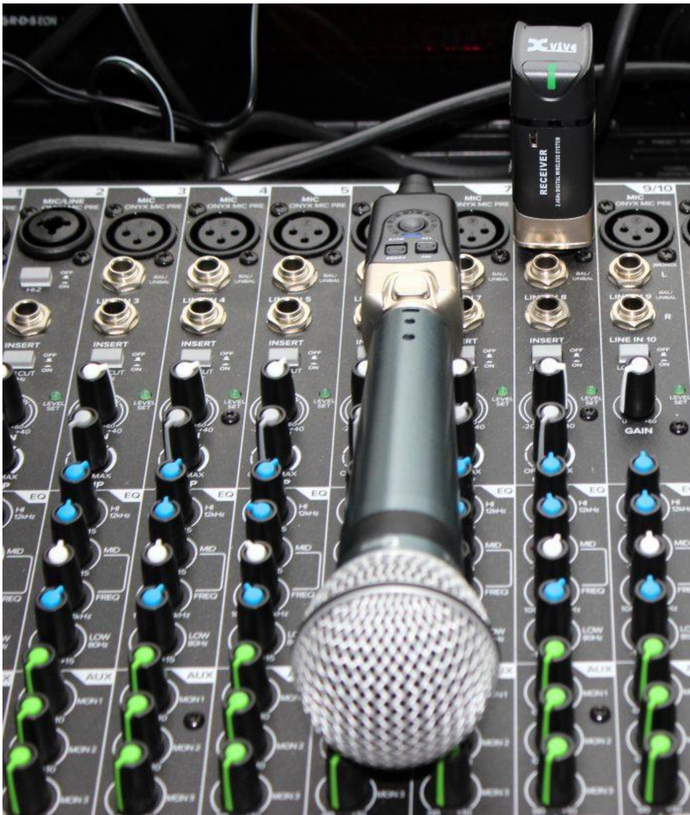
Im Test funktionierte die U3C-Funkstrecke auch mit einem dynamische Mikrofon problemlos
