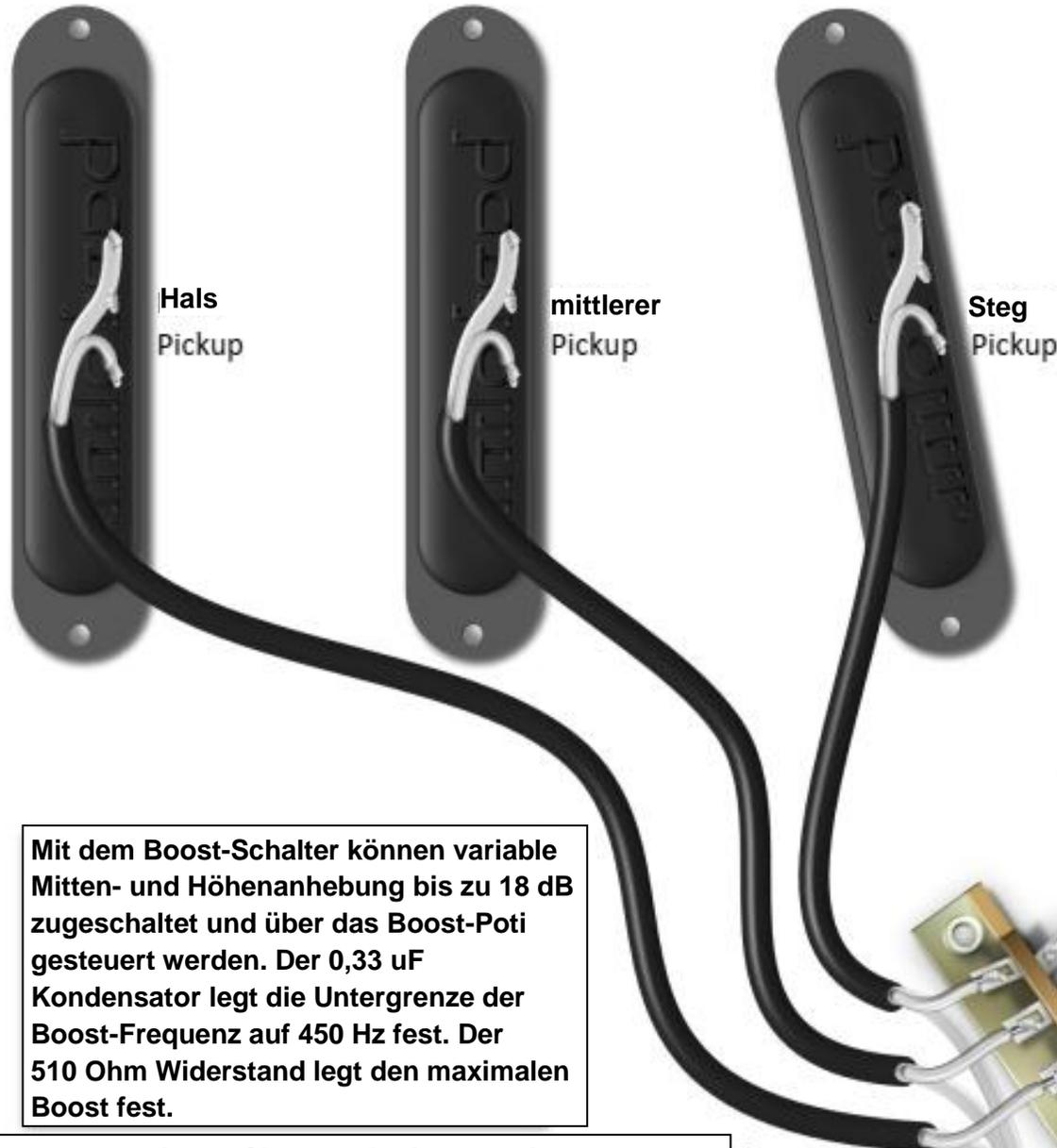
Mit dem Boost-Schalter können variable Mitten- und Höhenanhebung bis zu 18 dB zugeschaltet und über das Boost-Poti gesteuert werden. Der 0,33 uF Kondensator legt die Untergrenze der Boost-Frequenz auf 450 Hz fest. Der 510 Ohm Widerstand legt den maximalen Boost fest.
