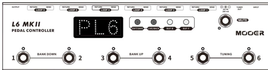
Pour accéder à l'accordeur intégré, pressez simultanément les footswitches 5 et 6. Cela coupera la sortie master du L6 MKII et le panneau d'affichage à LED affichera l'interface claire d'un accordeur.
