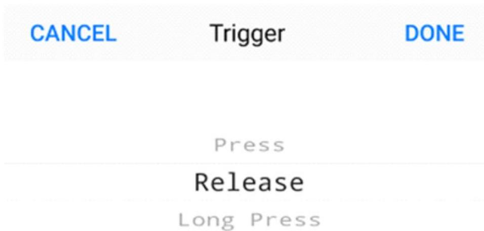
Les footswitchs de l'AIRSTEP peuvent être configurés selon trois mode de déclenchement : presser, relâcher, et pression longue. Chaque footswitch peut envoyer jusqu'à 8 messages différents et chaque message peut correspondre à un mode de déclenchement.
