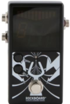
Má dva zapuštěné spínače. Center určuje nastavení základního tónu. Detune zase podladeň o jeden, dva nebo tři půltóny. Co je nešikovné, je, že typ podladeň se zobrazí jen na pár vteřin při aktivaci. Pak už se tato signalizace neobjevuje. Naštěstí se volba po odpojení napájení vymění. Takže když po divokém večírku zapomeneme, že jsme podlaďovali, ladička je na tom stejně.
