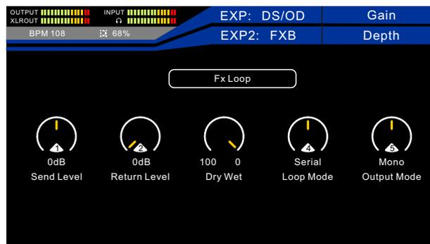
Réglez le niveau de départ (Send Level) et le niveau de retour (Return Level) en fonction de vos effets externes. Sélectionnez le bon mode de sortie (Output Mode Mono/Stereo). Sélectionnez le mode de boucle (Loop Mode) correct, c'est-à-dire série/parallèle (Serial/Parallèle).
