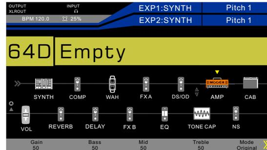
Les utilisateurs expérimentés peuvent obtenir un contrôle supplémentaire sur les niveaux de départ et de retour pendant le processus de capture en amenant le symbole de départ avant le bloc d'effets CAB et le symbole de retour après le bloc d'effets CAB.
