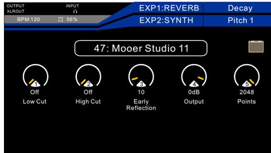
Lorsqu'un fichier IR de tierce partie est utilisé pour votre modélisation de baffle, vous perdez la possibilité de régler les paramètres de microphone, mais vous continuez de pouvoir régler les paramètres High/Low cut, Early Reflection, Output et Points.
