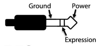
Für die meisten Expression-Pedale wird ein 6,35mm-Klinkenstecker verwendet, wohingegen beim Control-Input des L.A. Lady ein 3,5mm-Stecker zum Einsatz kommt. Um trotzdem eine Verbindung herzustellen, kann ein einfacher TRS-Stecker-Converter (6,35mm auf 3,5mm) verwendet werden.
