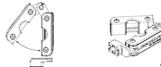
Les enrouleurs de cordes sont disponibles en deux versions et peuvent être facilement échangés en les tirant hors de l'axe de rotation. La version pour guitares dispose d'un extracteur de cheville supplémentaire.
