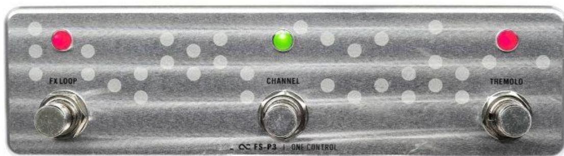
Im Gegensatz zu der RJ Verbindungsbuchse strotzt der Dreifachfußschalter geradezu vor massiver Verarbeitung. Das Gehäuse macht den Eindruck, als ob es aus einem massiven Aluminiumblock herausgefräst worden sei, wobei die Bodenplatte passgenau eingelassen wurde. Für einen besseren Halt auf glattem Untergrund liegen vier aufklebbare Pads bei. Geschaltet wird die Kanalwahl, die Tremolo-Einheit und der FX-Loop.
