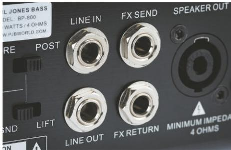
Die Buchsen Line Out und Line In können als zweiter Effektweg hinter dem DI-Abzweig genutzt werden.
