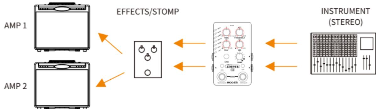
In dieser Konfiguration wird das Stereosignal direkt vom Instrument aufgenommen, ohne irgendwelche Effekte.
