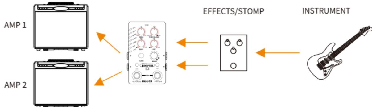
In dieser Konfiguration wird das durch Effekte verarbeitete Stereosignal aufgezeichnet.
