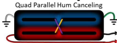
Spulen mit Magnetpolarität **NORD** sind **ROT** dargestellt. Spulen mit Magnetpolarität **SÜD** sind **BLAU** dargestellt.
