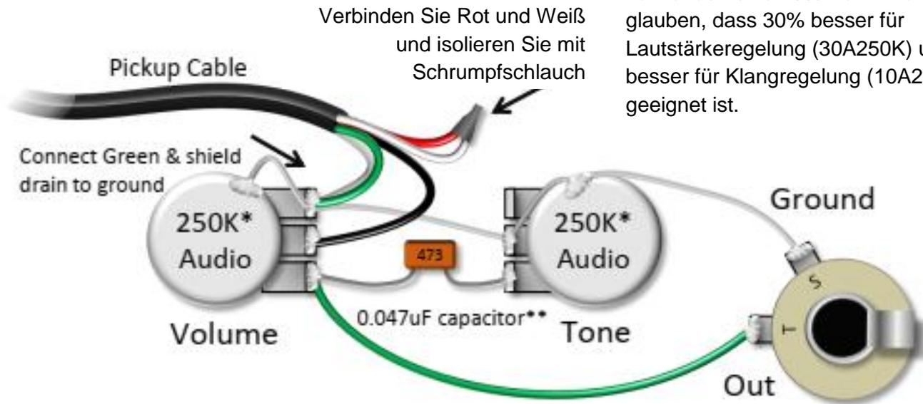
**Verbinden Sie Grün und das blanke Abschirmungskabel mit Masse (Ground).**
