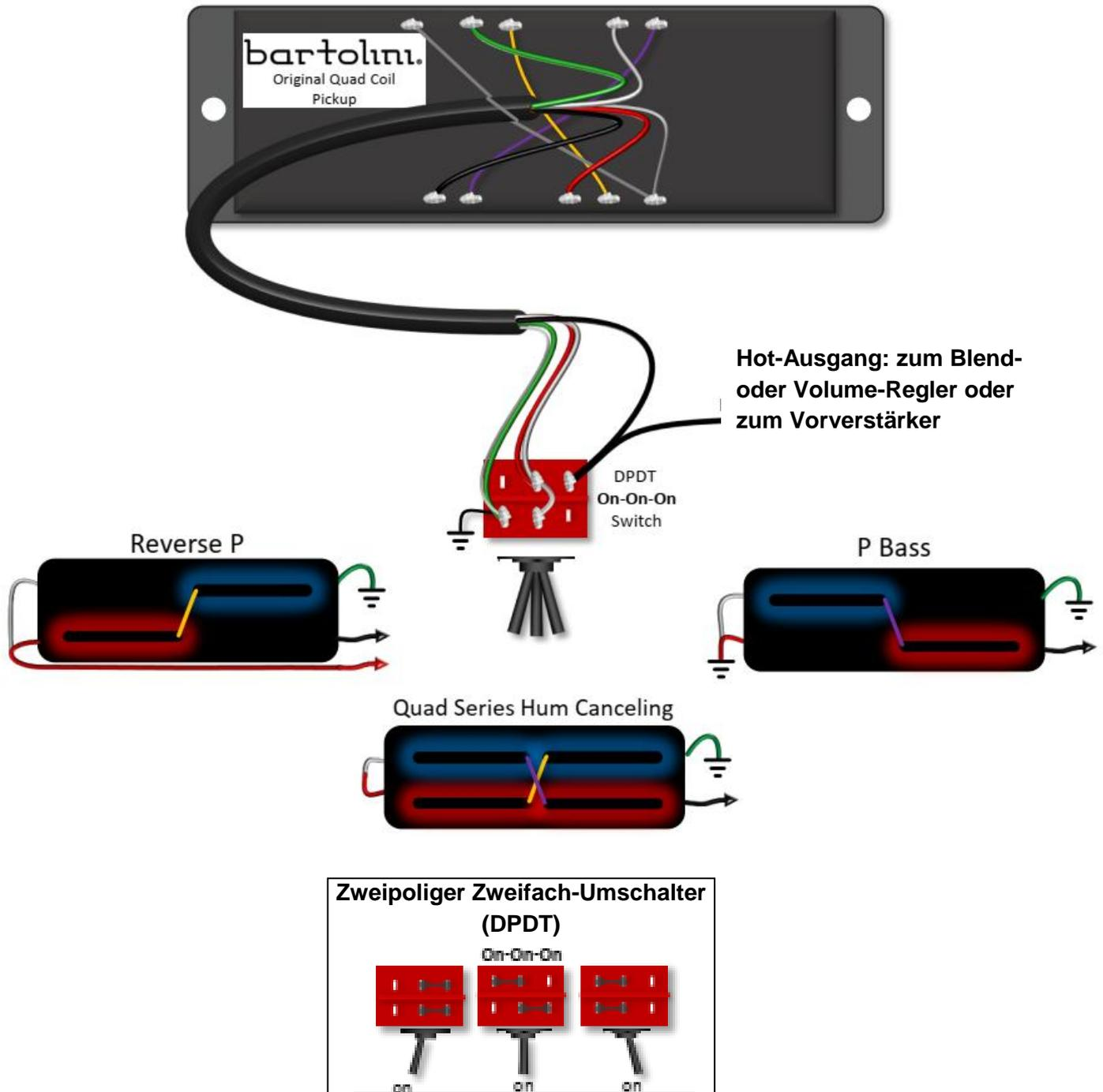
Spulen mit Magnetpolarität **NORD** sind **ROT** dargestellt. Spulen mit Magnetpolarität **SÜD** sind **BLAU** dargestellt.
