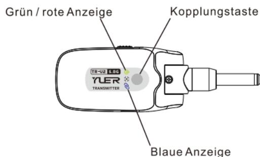
Schalten Sie Sender und Empfänger ein und drücken Sie die Kopplungstaste am Empfänger, bis die blaue Anzeige schnell blinkt. Drücken Sie dann die Kopplungstaster am Sender für mehr als 2 Sekunden. Bei erfolgreicher Kopplung leuchten die blauen Anzeigen an Sender und Empfänger beide durchgängig.
