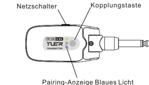
Schalten Sie Sender und Empfänger ein und drücken Sie die Kopplungstaste am Empfänger, bis die blaue Anzeige schnell blinkt. Drücken Sie dann die Kopplungstaster am Sender für mehr als 2 Sekunden. Bei erfolgreicher Kopplung leuchten die blauen Anzeigen an Sender und Empfänger beide durchgängig.
