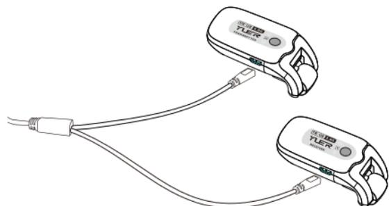
★ Mit dem USB Y-Kabel können Sender und Empfänger gleichzeitig geladen werden.
