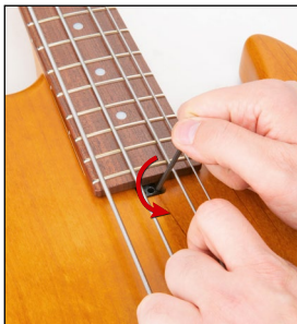
Straffer Halsstab mit Halskrümmung nach hinten (konvex), tiefe Saitenlage.
